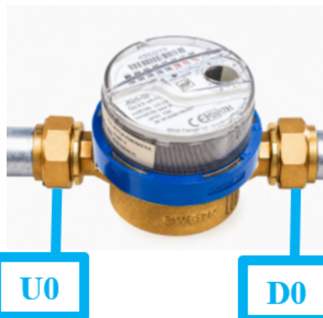
Osnovni vodomjer MT-SMARTMESS-JS-CW ne zahtijeva ulazne i izlazne dijelove prije i poslije vodomjera (U0D0)
