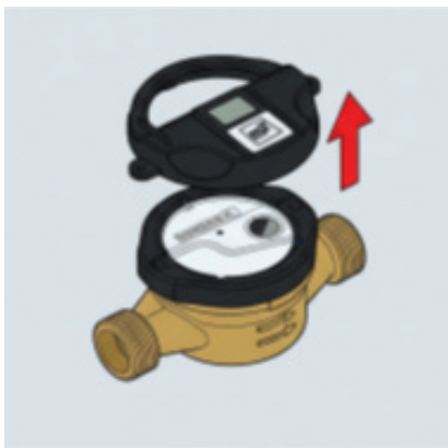
Uklonite radio adapter MT-WMRA2 s vodomjera za stan MT-SMARTMESS-JS-CW okomito prema gore.
